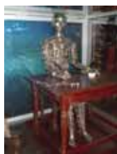
Fig 6. Un exemplu de automat: automatul lui Hugo Cabret, care este doar de natură mecanică și care poate executa doar o singură sarcină: să deseneze.
