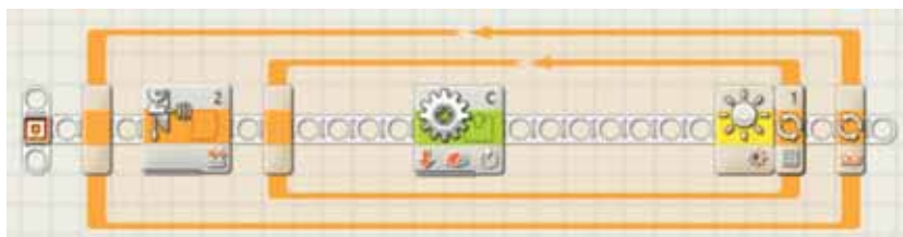
Fig 7. Acest program este o extensie a celui anterior. Aici robotul începe să dea cu spatele atunci când are ceva în față și se oprește atunci când terenul are culoarea verde.
