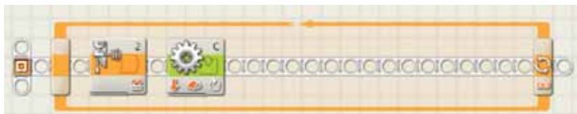
Fig 3. Acest program face robotul să dea cu spatele atunci când se apropie ceva (adică, atunci când senzorul de ultrasunete detectează prezența unui obiect). Primul bloc face robotul să aștepte apropierea unui obstacol iar al doilea bloc îl face să întoarcă motorul în sens opus acelor de ceasornic. Cele două blocuri sunt înconjurate de un ciclu while parametrizat ca infinit.
