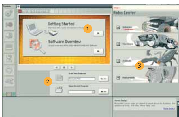
Fig 1. Aplicația Lego NXT: (1) Tutorialul „Inițiere”, (2) spațiul de deschidere a unui nou proiect și (3) Centrul Robotic, cu instrucțiunile de construcție și programare. Lego Robots are o interfață pe calculator mulțumită lui NXT, un limbaj cu pictograme bazat pe National Instruments Labview 1 (Fig. 8).
