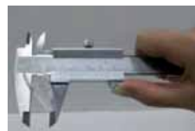
Fig 2. Măsurarea cu șublerul
