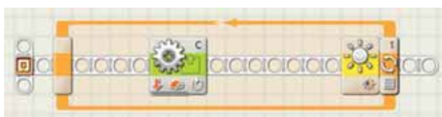
Fig 6. Acest program face robotul să dea cu spatele până când ajunge pe teren de culoare verde. Bucla este conectată la senzorul de lumină, făcând motorul să meargă până când senzorul sesizează culoarea verde.
