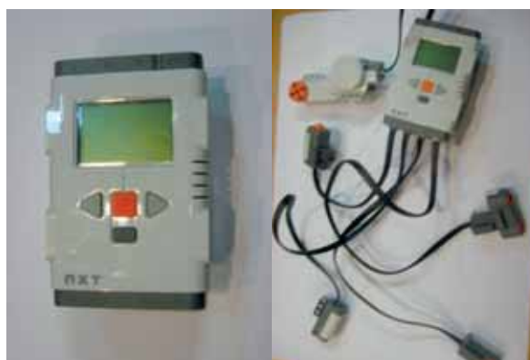
Fig 3. În stânga: Modulul procesor Lego Mindstorm NXT® include un ecran pentru vizualizarea unui set de meniuri pentru programe trial încorporate; a programelor create de elevi prin interfață sau direct pe modulul procesor; pentru vizualizarea valorilor senzorilor și servomotoarelor, a mesajelor bluetooth etc. Săgețile pot fi folosite pentru a derula meniurile, butonul portocaliu se utilizează pentru a executa programul, iar butonul gri pentru întoarcerea la meniu sau pentru oprirea robotului. În dreapta: Senzorii și motoarele conectate la procesor.
