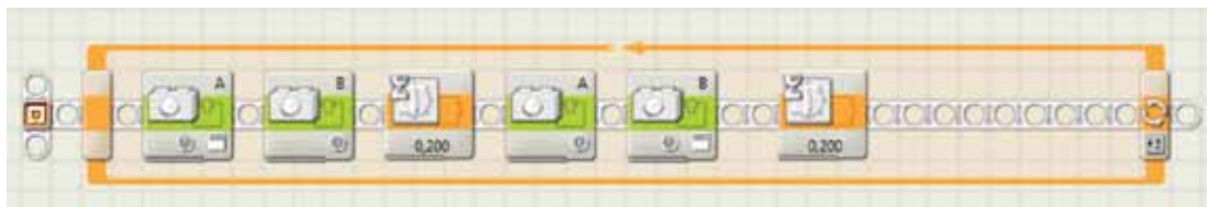
Fig 1. Prin introducerea buclor, acest program pornește și oprește cele două becuri ale robotului, ca o lumină de tip revolving. Lampa conectată la portul A este activată cu o valoare a intensității luminoase de 50 și lampa conectată la portul B este oprită. După o pauză de 2 secunde, în schimb, lampa de pe portul A este oprită și lampa de pe portul B este activată. O pauză de două secunde urmează din nou. Cele șase blocuri sunt într-un ciclu while parametrizat de un contor. În acest exemplu, contorul este setat la 15.
