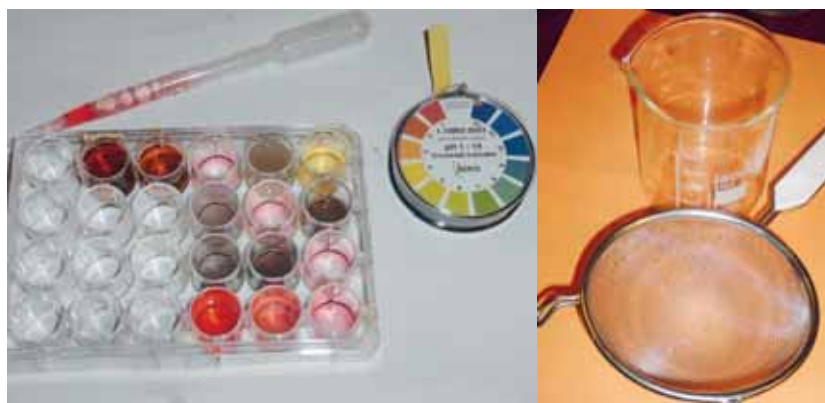
Fig 1. O placă cu godeuri, o pipetă, hârtie de pH, un pahar Berzelius și o sită
