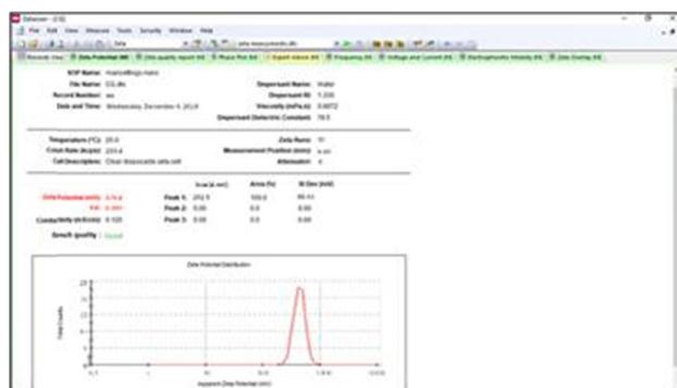
Figure 5. Zetasizer results ( $\text{Fe}_3\text{O}_4@\text{SiO}_2$  - 2x)
